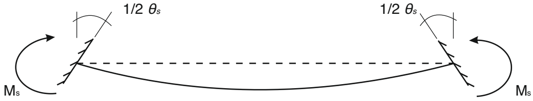
Figura 8: Asta doppiamente incastrata con curvatura simmetrica
